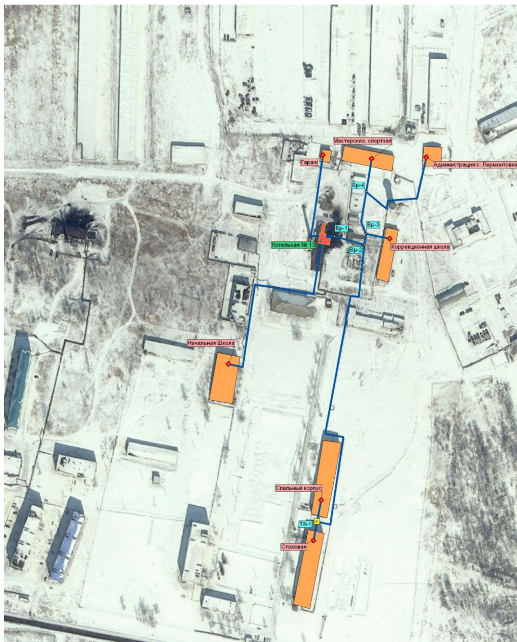
Рис. 2.5 – Схема тепловых сетей котельной №13
