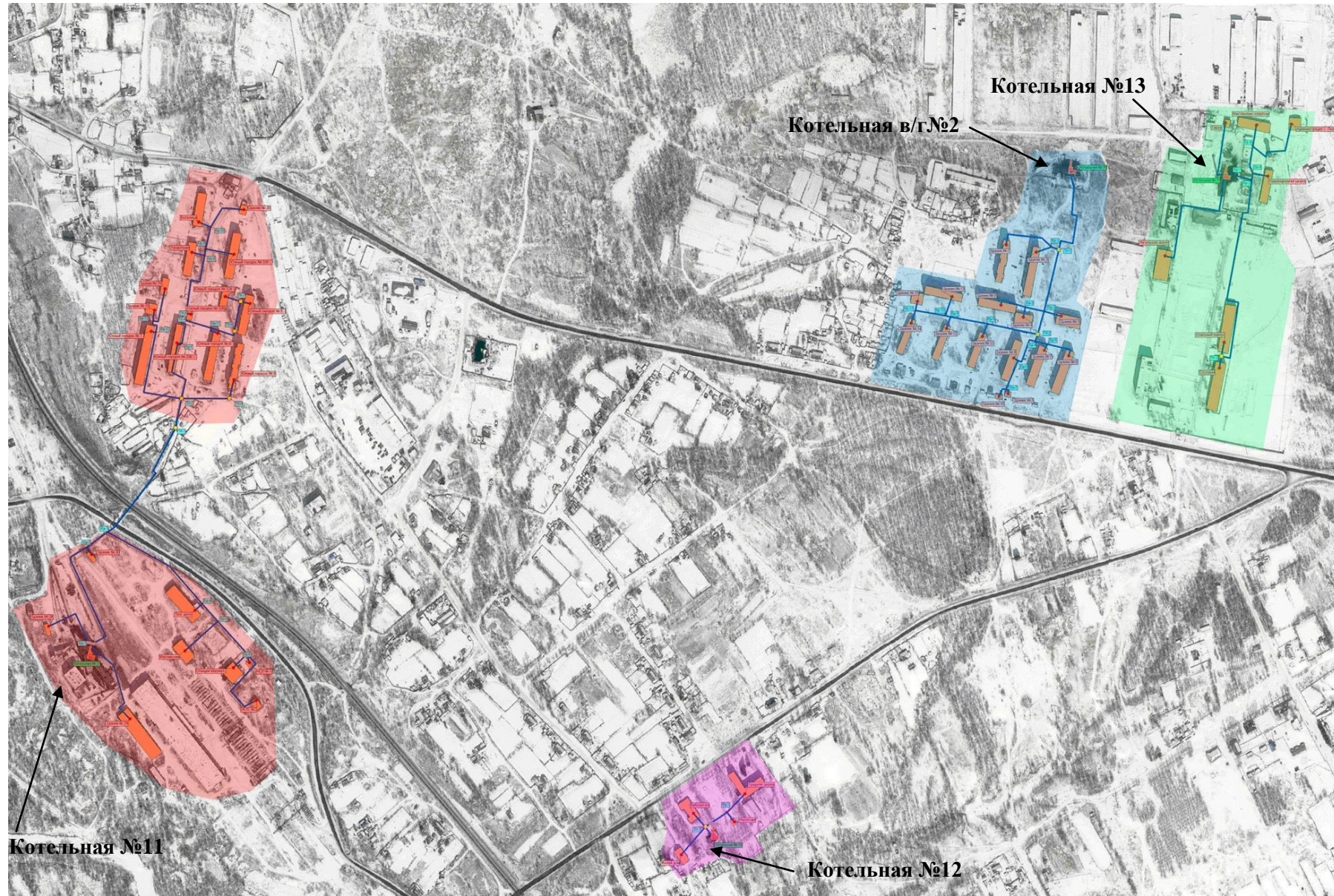
Рисунок 1.2. – Зоны действия источников тепловой энергии с. Лермонтовка
